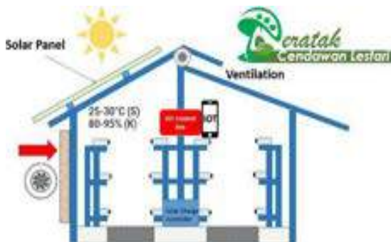
Rajah 2. Sistem Kawalan Suhu dan Kelembapan Versi 2 (V2)
